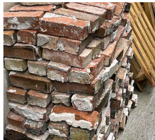
Récupération, nettoyage et réemploi des briques pour réaliser les cheminements extérieurs en périphérie du bassin de pluie
